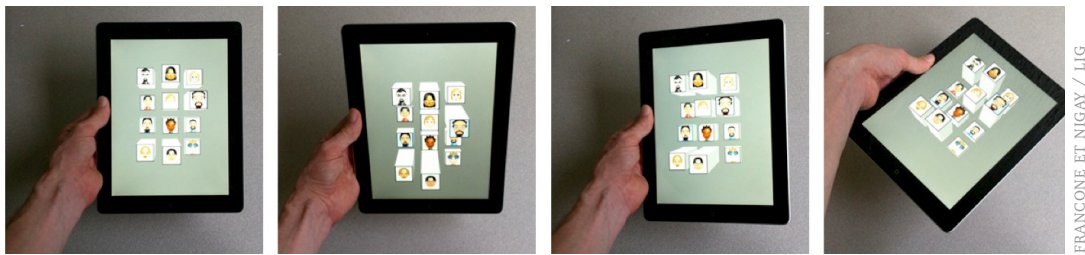
FIGURE 6.2 — Illustration d'un rendu fish-tank sur appareil mobile, basé sur le changement de parallaxe [Francone et Nigay 2011].
