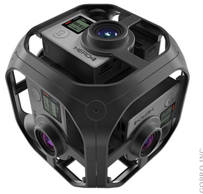
FIGURE 6.6 — Le GoPro Omni, un appareil capable de filmer à 360°. Mais contrairement à l’approche que nous proposons, ce dispositif n’a pas vocation à être couvert d’une surface d’affichage ce qui simplifie le placement des caméras.
