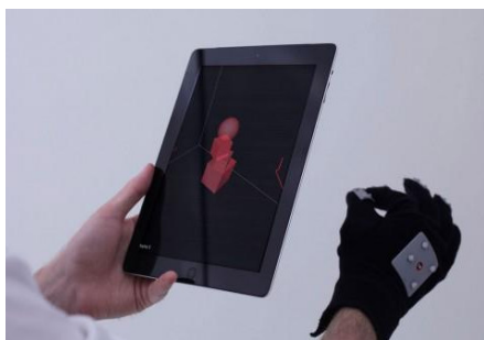
(a) « T(ether) » [Blackshaw et al. 2012]. Malgré l'utilisation d'un appareil mobile, l'interface demeure intrusive car l'utilisateur doit porter un gant. Le système de suivi externe limite par ailleurs sa portabilité.
